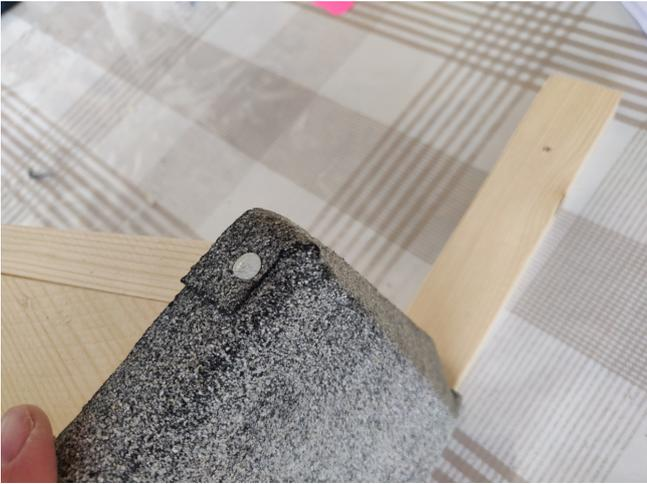
Abbildung 14: Mit Nagel befestigen.
